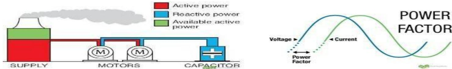
En un aparato eléctrico el voltaje puede alcanzar su punto máximo antes que la corriente, lo cual crea un desfase, lo que produce cambios en el factor de potencia. Si los KVA de un equipo es superior a sus KW, entonces el consumo en KVA es mayor que la potencia que produce en KW.
